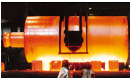
165 吨 ESR 钢锭，2,300 毫米直径 x 5,000 毫米长
